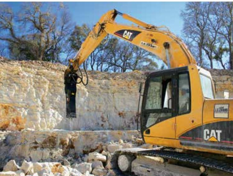
Los martillos hidráulicos CAT pueden ser instalados en todas las excavadoras hidráulicas.
