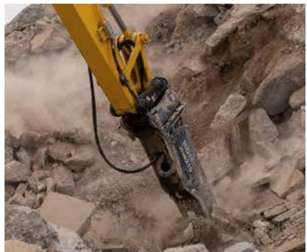
El martillo hidráulico se acciona a través de un flujo especial que sólo funciona a presiones muy elevadas.
