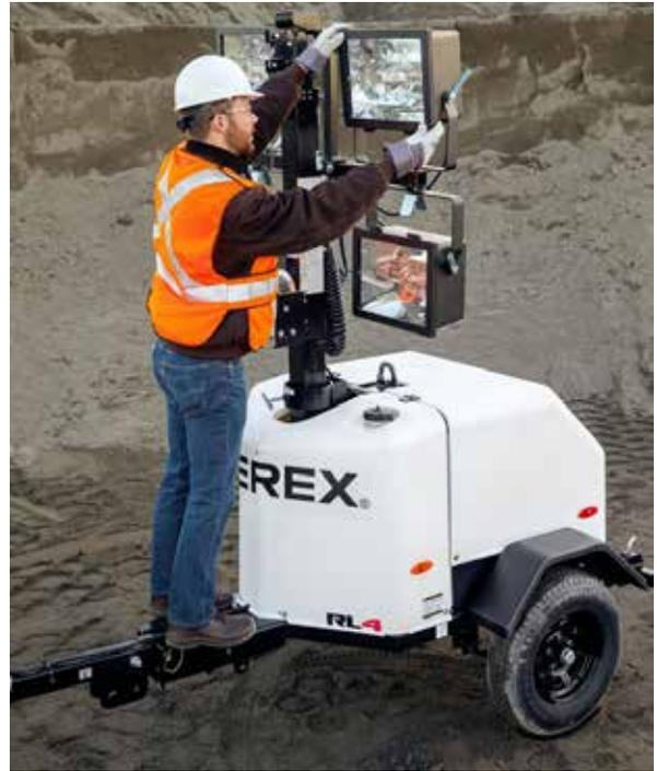
La torre de iluminación está compuesta por un motor diésel y un generador eléctrico acoplados de manera directa que, en su conjunto, forman la fuente de energía necesaria.
